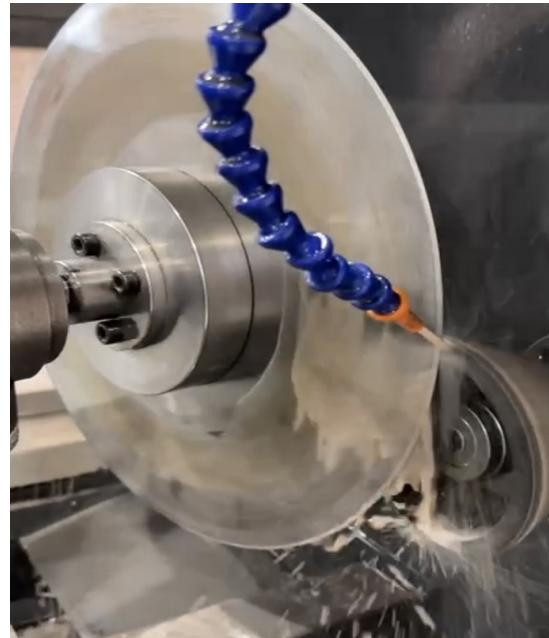
Станок **RMS-NC.R** предназначен для заточки различных дисковых ножей с правильной круглой режущей кромкой. Так же на станке можно точить различный специальный инструмент, например, волчковые ножи, трубчатые фрезы и т.д.\*
